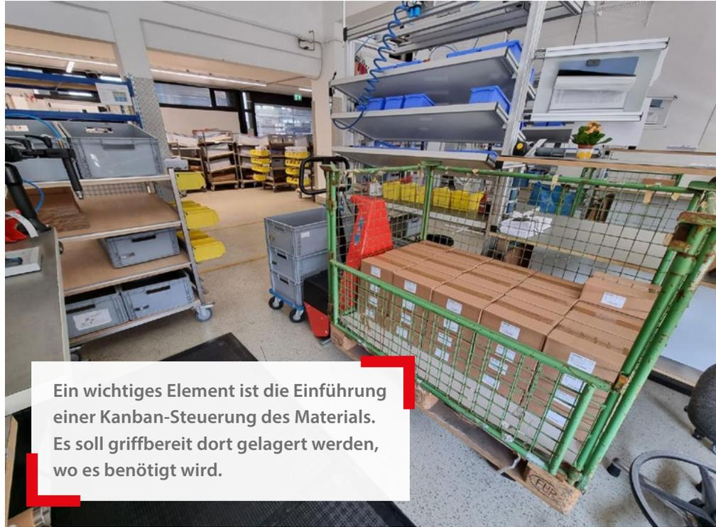
Ein wichtiges Element ist die Einführung einer Kanban-Steuerung des Materials. Es soll griffbereit dort gelagert werden, wo es benötigt wird.
